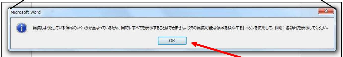
A1. 使用しているパソコン (Word のバージョン・設定等) によって発生する場合がある。注意画面は OK をクリックして問題なし。画面上部の『表示』タブをクリックして、『文章の編集』をクリックすれば文字入力・印刷・保存が可能になる。
